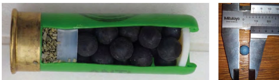
Figuras N° 11 y 12. Corte transversal y dimensiones de una esfera del lastre.
