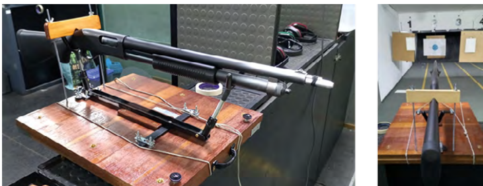
Figuras N° 13 y 14. Vista del soporte construido para las pruebas.
