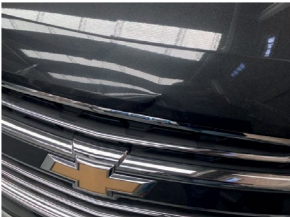
Figura N° 11. Detalle. Se observa un daño de características similares a los dejados por cuerpos de dureza homogénea de poca masa. Fuente: Producción propia.
