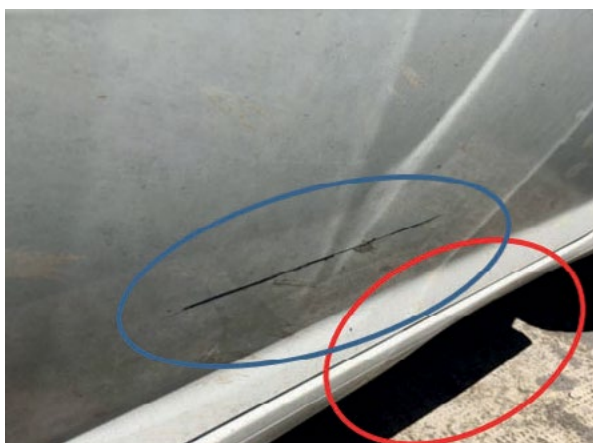
Figura N° 1. Dos daños de distinta altura. Fuente: Producción propia.
