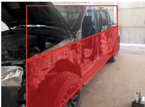
Figura N° 4. En la figura se indica el sector medio inferior afectado por la colisión. Fuente: Producción propia.
