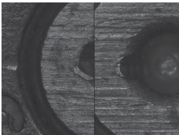
Figura N° 7. Documentación en yuxtaposición de las características transmitidas por el espaldón a las vainas servidas testigos obtenidas de la pistola N° 11-606592 (izquierda) y de la pistola N° 11-606588 (derecha). Fuente: producción propia.
