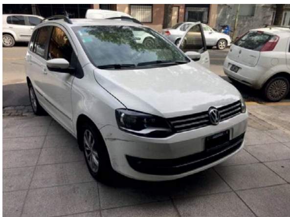
Figura N° 13. En la figura se observan daños leves en el sector fronto-angular derecho. Fuente: Producción propia.
