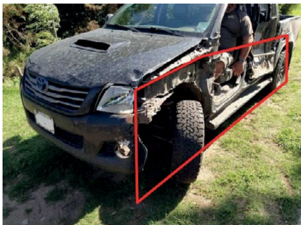
Figura N° 3. Se observan daños en el lateral izquierdo. Fuente: Producción propia.
