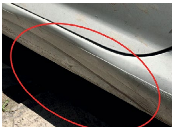
Figura N° 2. En esta figura se observan daños dejados por un elemento de una altura menor al objeto denunciado. Fuente: Producción propia.
