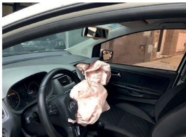
Figura N° 14. Interior del rodado siniestrado, donde se observan los airbag activados. Fuente: Producción propia.
