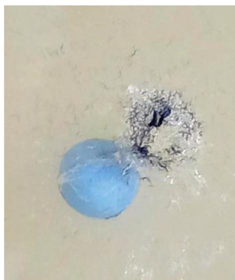
*Figuras N° 43 y 44. Taco conteniendo la posta que obtuvo la mayor penetración y detalle del proyectil.*
