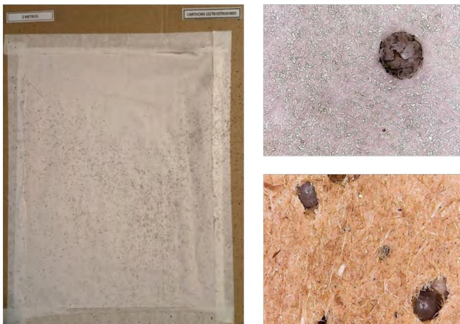
*Figuras N° 27, 28 y 29. Detalles de los impactos a 2 m.*
