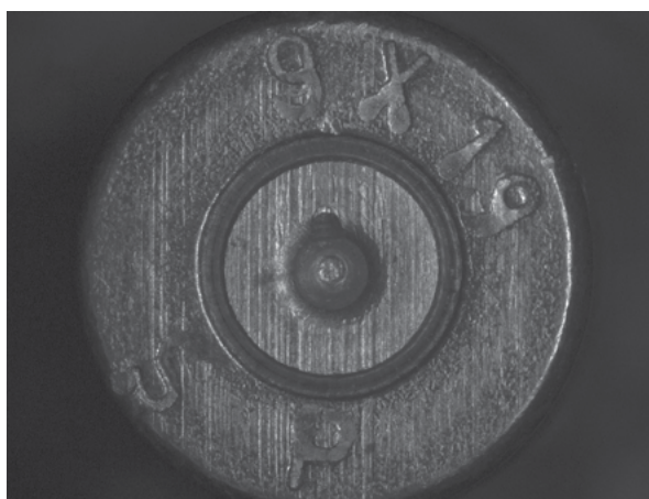
Figura N° 6. Documentación de los culotes de las vainas servidas testigos obtenidas de la pistola N° 11-606592 (izquierda) y de la pistola N° 11-606588 (derecha). Fuente: producción propia.
