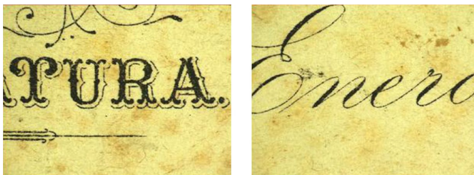
Figura N° 3. Detalle de impresión tipográfica cilíndrica plana. Muestra de la morfología del sistema de impresión utilizado en el membrete del documento.
