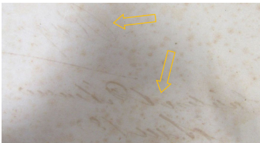
Figura N° 6. Vista del reverso del documento que evidencia la transferencia del material tintóreo hacia la cara contraria del soporte. Fuente: División Scopometría - Policía Federal Argentina.
