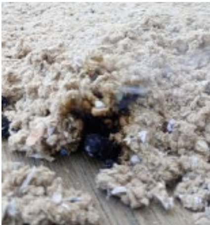
Figura N° 5: Muestra de celulosa. Inicio de fuego controlado fuera de una estructura. El smoldering, crea una capa superficial sin decoloración, sin embargo, debajo el material comienza a pirolizar de manera imperceptible.
